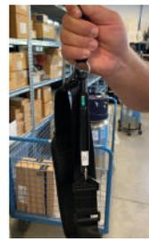
Zum Überprüfen des Füllstandes mit der mechanischen Füllstandanzeige, heben Sie den Tragebehälter am Gewebeband nach oben. An der Farbskala können Sie dann den Füllstand ablesen. **Hinweis:** Tragebehälter nach dem Befüllen 15 Minuten ruhen lassen.
