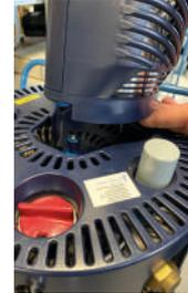
Der Tragebehälter wird mit leichtem Druck auf die Füllstation aufgesetzt!
