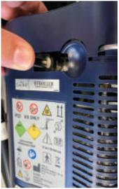
Danach wird der Seitenhebel gezogen und der Sauerstoff fließt in den Tragebehälter. Schließen Sie das Entlüftungsventil, sobald der Tragebehälter gefüllt ist. Einen gefüllten Tragebehälter erkennen Sie daran, dass sich das Geräusch des Füllvorganges verändert und Flüssigkeit aus dem Entlüftungsventil austritt.
